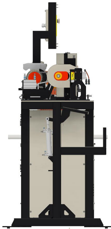
نمای کلی ماشین صاف کن و برش دیسکی مدل CTC-202-02
